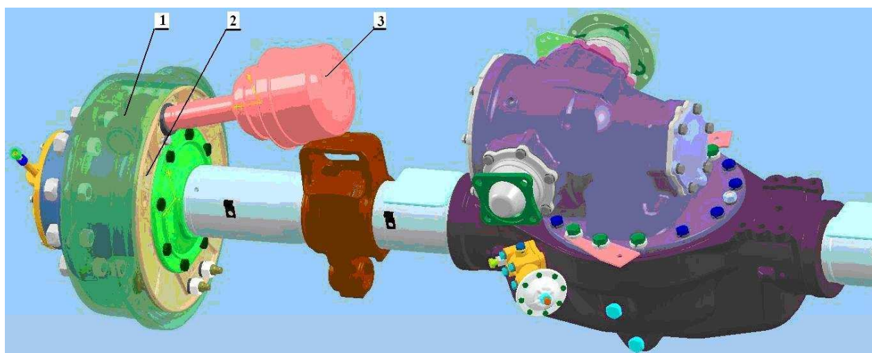
1- клиновой механизм, 2- суппорт тормоза, 3- камера тормозная с энергоаккумулятором
