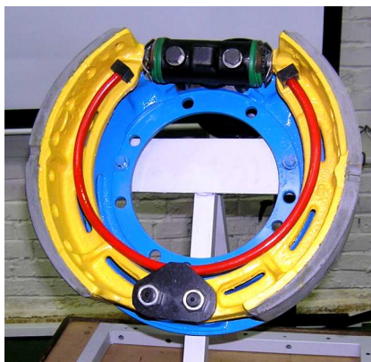
Рис. 8 Суппорт тормоза с клиновым механизмом в сборе
