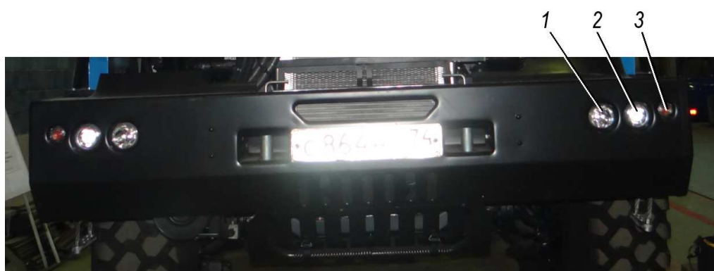
1-фара дальнего света; 2-фара ближнего света; 3-фонарь передний (указатель поворота/габаритный огонь)
