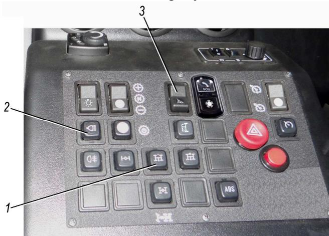
1-выключатель коробки отбора мощности (КОМ); 2-выключатель фары-прожектора и фонаря освещения погрузочной площадки; 3-переключатель подъема/опускания платформы
