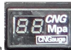
Дополнительно в кабине автомобиля размещен индикатор давления газа (при комплектации автомобиля системой индикации давления газа в системе топливоподачи). Индикатор давления газа предназначен для визуального контроля из кабины автомобиля давления газа в магистрали высокого давления основной газовой системы по показаниям датчика-индикатора давления газа.
