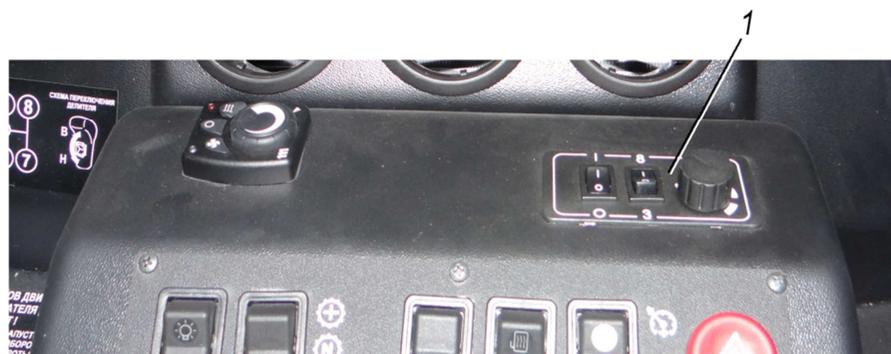
1- пульт управления газовым предпусковым подогревателем
